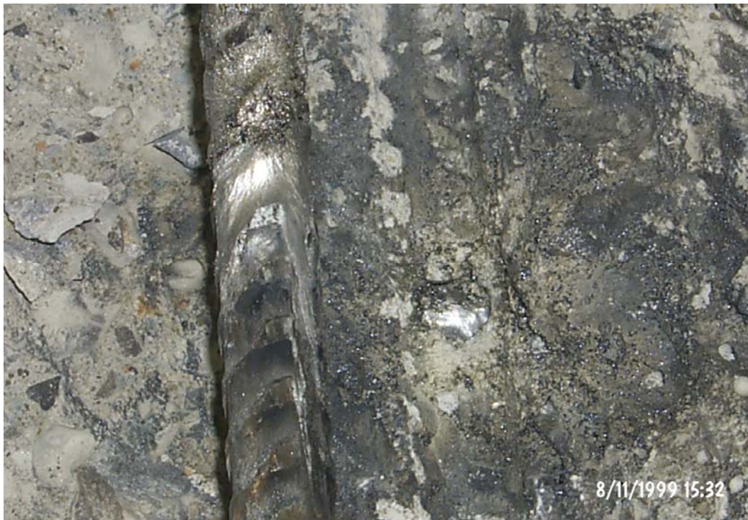
Bild 17: Prüfung der Bewehrungsstab-Kreuzung im Beton: Zerstörter Prüfling C13 nach dreimaliger Belastung mit 100 kA 10/350.
