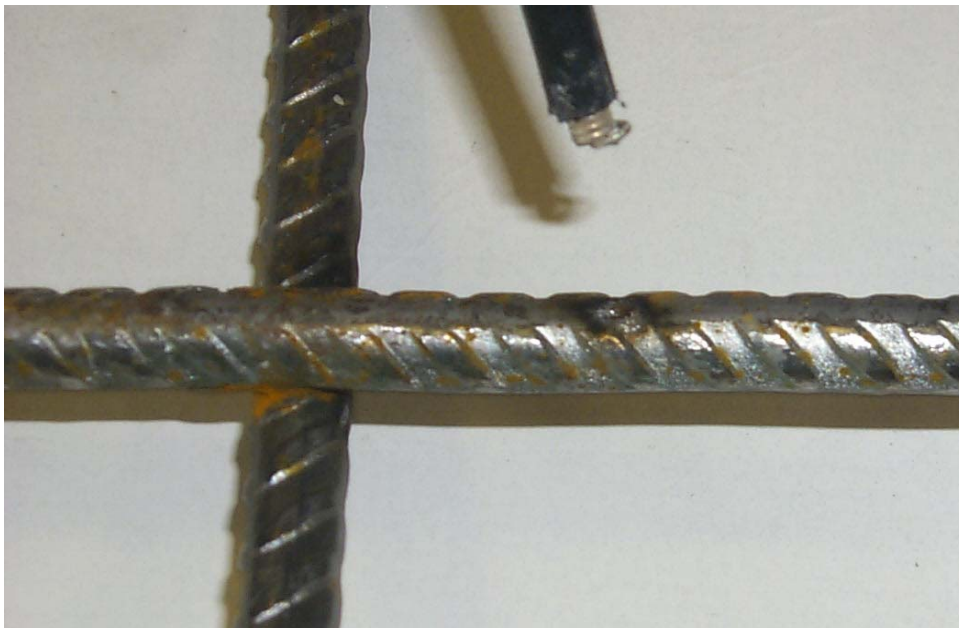
Bild 16: Prüfung der Bewehrungsstab-Kreuzung im Beton: Lediglich geringfügige Ausschmelzung an freigelegter Bewehrung des Prüflings C8 nach dreimaliger Belastung mit 100 kA 10/350.
