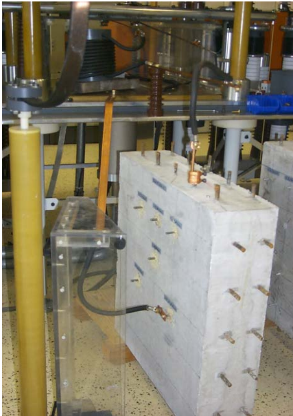
Bild 5: Prüfling B: Betonplatte 800 x 800 mm 2 mit mehreren Anschlüssen.
