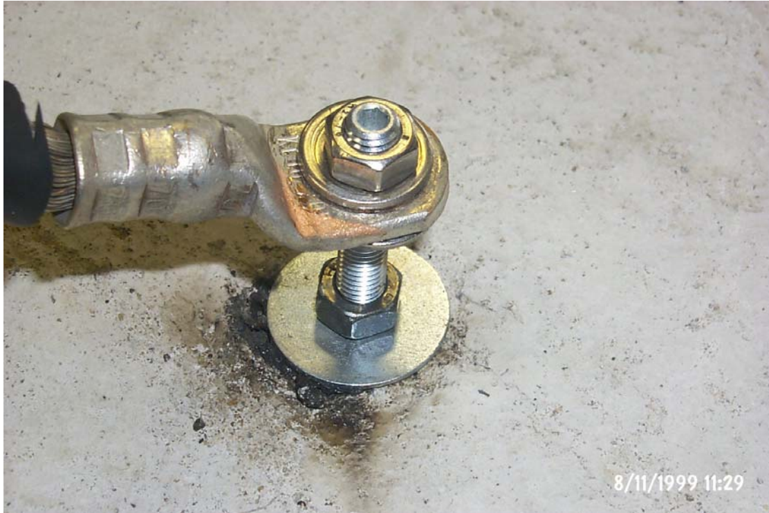
Bild 9: Anschlussvariante „0“: Gewindestange mit Metalldübel im Bohrloch.
