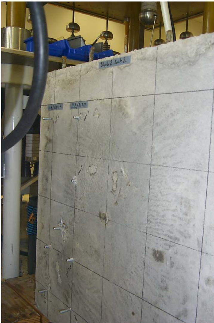
Bild 14: Anschlussvariante „II“: Bolzensetzen.
