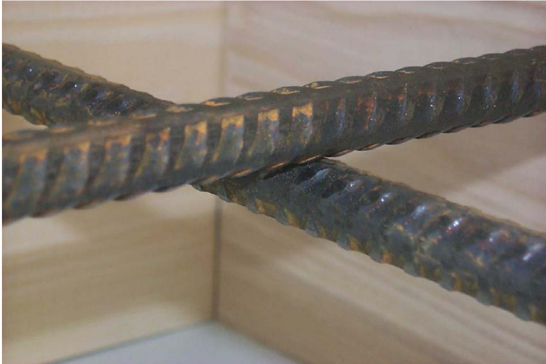
Bild 3: Prüfling A: Detail der Kreuzung (Abstand 1 mm).
