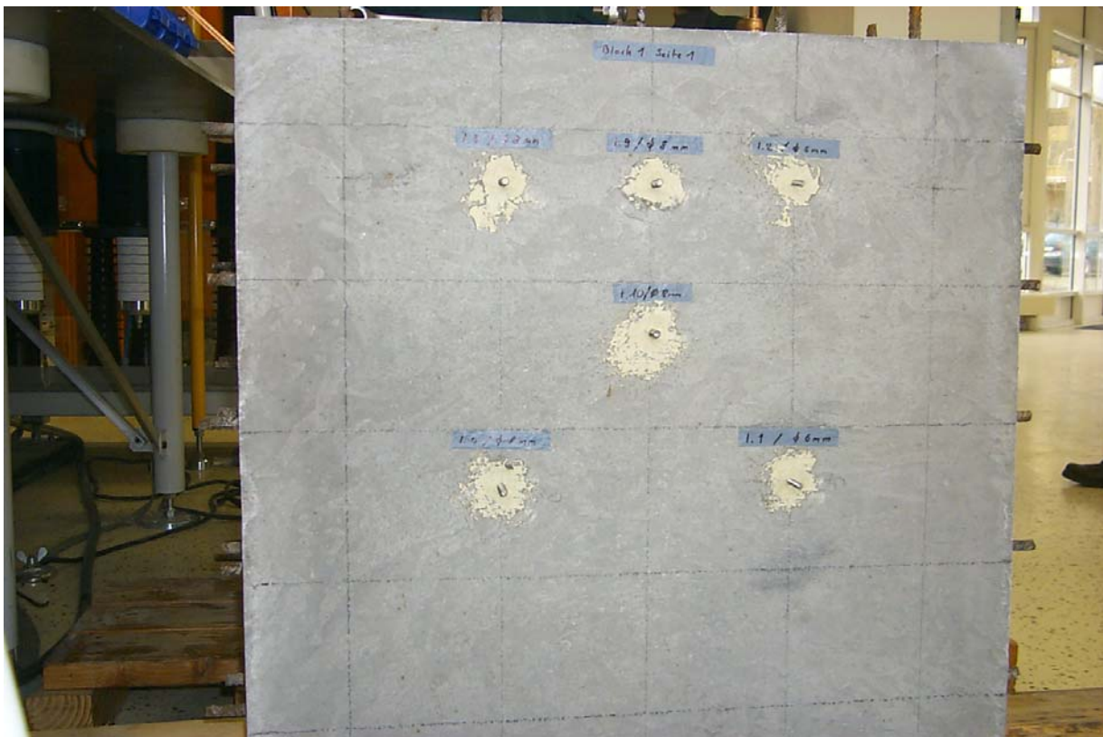
Bild 12: Anschlussvariante „I“: Bolzenschweißen (Prüflinge I.1 – I.4, I.9, I.10).
