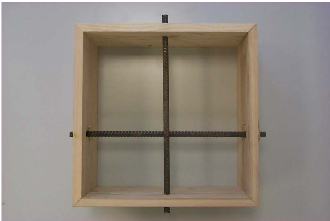
Bild 2: Prüfling A: Anordnung der Bewehrungsstäbe.
