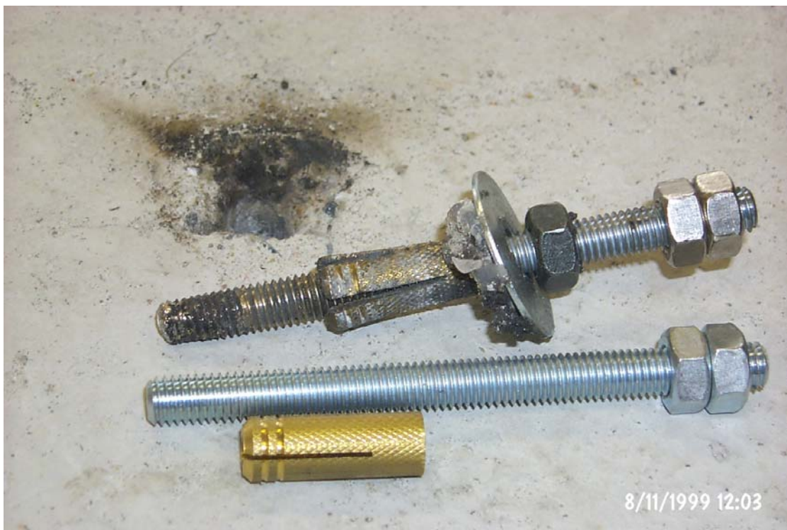
Bild 10: Gewindestange mit Metalldübel vor und nach einer Stoßstrom-Belastung 10/350 mit 100 kA Scheitelwert.
